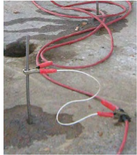
Figura 3: Elettrodi utilizzati per l'acquisizione geoelettrica
